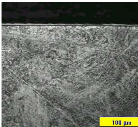
图2 三种不同沉积层的截面显微组织形貌
