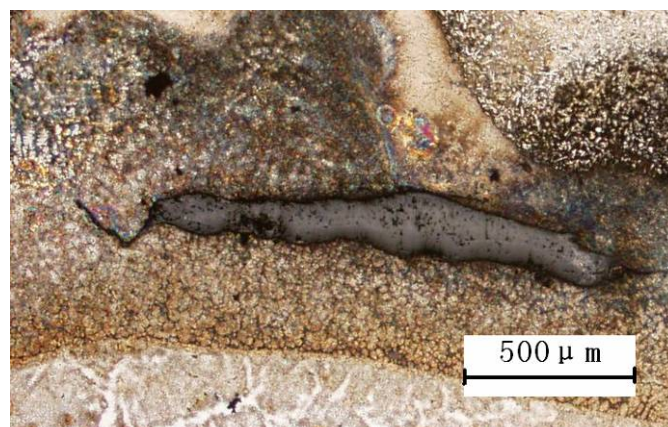
图 14 试样 5 熔敷层底部夹渣 50 ×
