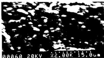
图3 Ni-P-Co合金沉积层的表面形貌(二次电子像)
