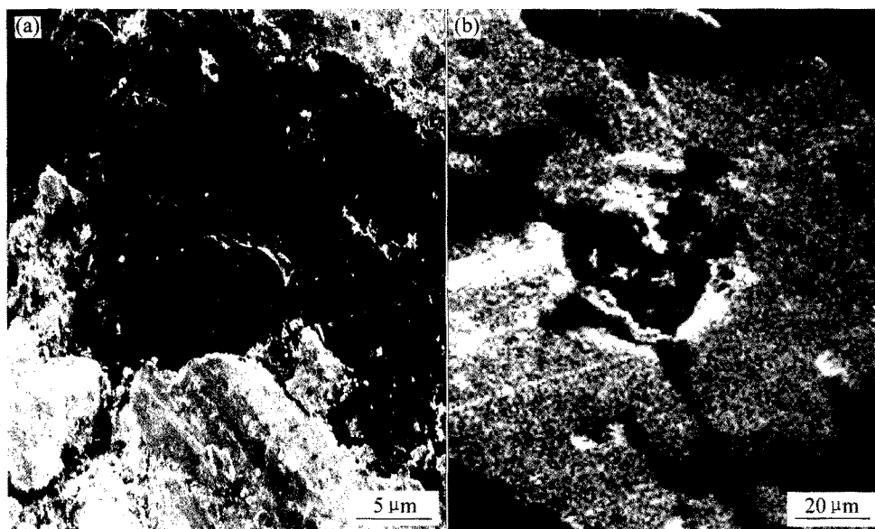
图7 石墨颗粒脱落后磨痕表面的形貌
