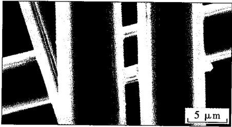
图 1 未处理过的碳纤维表面 SEM 照片 Fig. 1 SEM images of untreated carbon fiber
